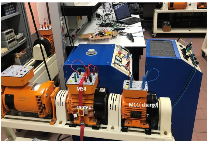
Fig. 19. Machine synchrone expérimentale saine MS4 de 1,2KW. La fréquence de l'harmonique sensible vaut 150Hz pour cette machine.
