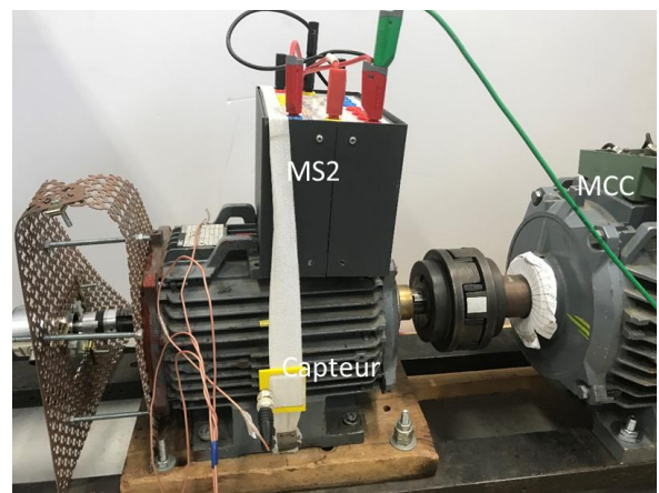
Fig. 13. Machine synchrone expérimentale MS2 de 4KW.
