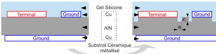
Figure 2 : Modification d'un substrat métallisé classique en structure mesa
