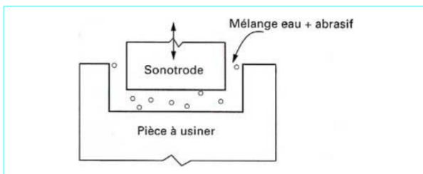
Figure 9 : principe de l'usinage par ultrason [20]
