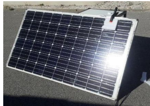
Figure 9 : Panneau sunmodule plus SW285, cellule entièrement ombrée.
