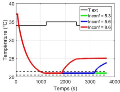
Fig. 3. Evolution de la température au cours du trajet pour différents indices d'inconfort. Les lignes en pointillés noirs indiquent le domaine de température confortable ( $\pm 0,5^{\circ}\text{C}$  autour de la valeur de consigne).
