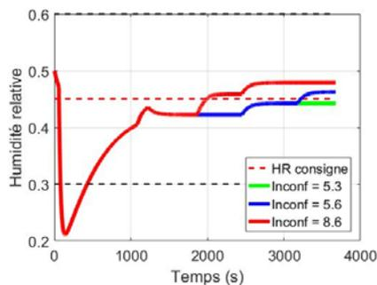
Fig. 4. Evolution de l'humidité relative au cours du trajet pour différents indices d'inconfort. Les lignes en pointillés noirs indiquent le domaine d'humidité relative confortable ( $\pm 15\%$  autour de la valeur de consigne).
