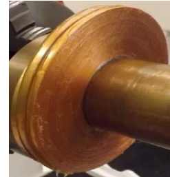
Fig. 3: Bobinage d'une galette SHTS [11]
