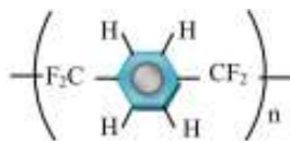
Fig. 7. Structure chimique du parylène AF4
