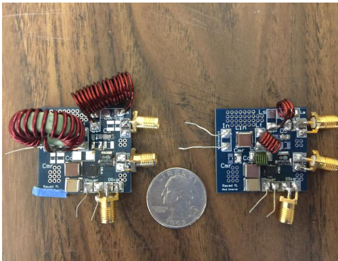
Figure 10. Classe E (à gauche), Classe \phi 2 (à droite)
