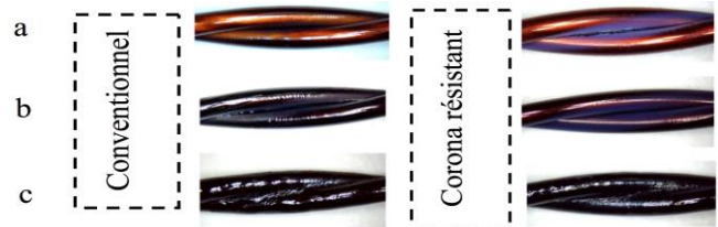
Fig.10. Observation microscopique des éprouvettes après défaillance : T = 20^\circ\text{C} , f = 50\text{kHz} , a – 1000V, b – 1200V, c – 1400V
