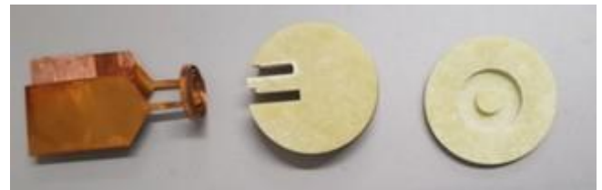
Fig. 3. Inducteur avec les profils inférieurs et supérieurs de l'isolation en fibre de verre.
