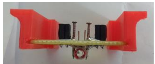
Fig. 9. Capteurs "B-H" avec sont support. Les pointes sont faites de avec deux pointes en laiton. La bobine d'induction est placé entre les points et est constitué de 200 spires.
