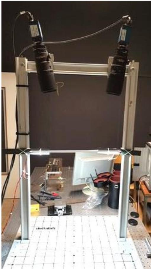
Fig. 7. Dispositif de stéréo-ocorrélation d'image.
