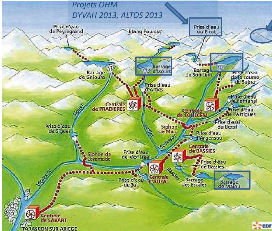
Plan des installations hydroélectriques EDF en vallée du Vicdessos
