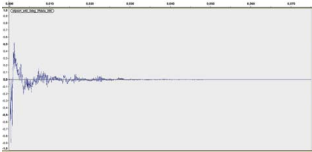
Figure 9. La réponse impulsionnelle de l'enceinte Elipson E40 (microphone orienté à 90° par rapport à son axe).
