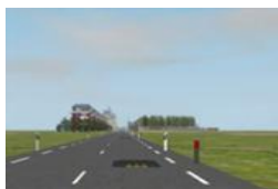
Illustration 4 : ralentisseurs implantés à 150 mètres, 100 mètres et 50 mètres du passage à niveau
