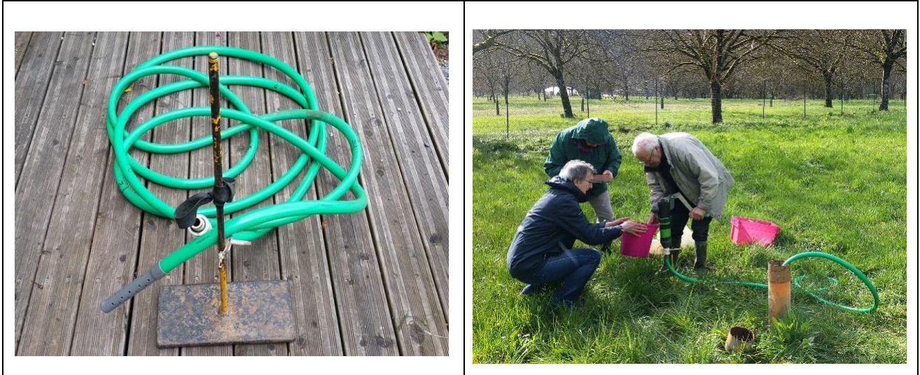
Appareillage pour pompage en piézomètre : détail et fonctionnement in situ
