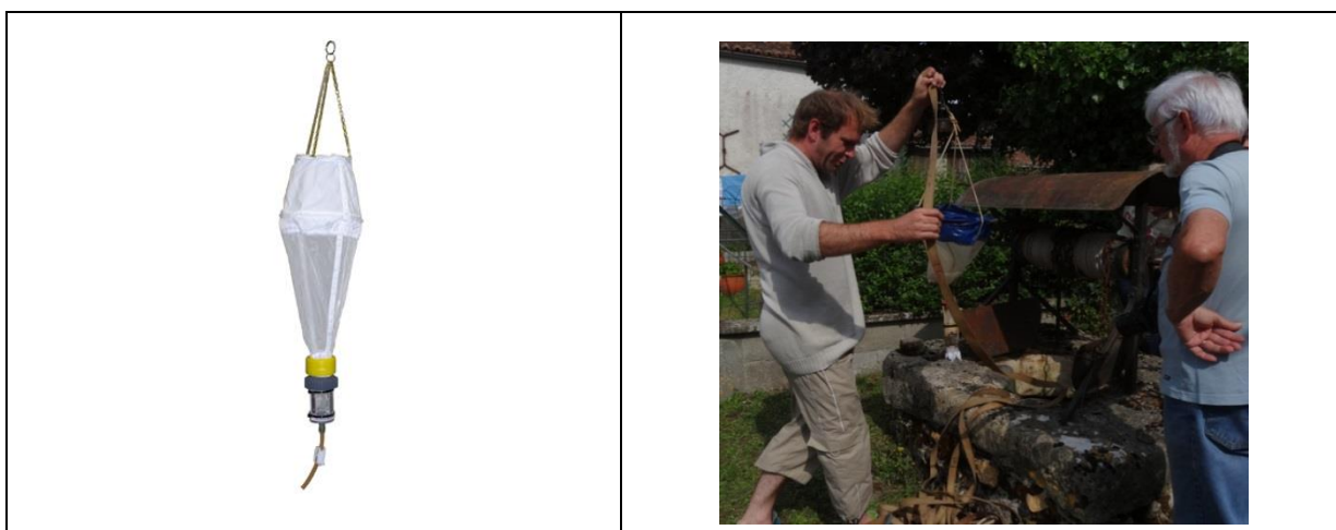
Filet Cvetkov ou phréatobiologique : détail et maniement in situ
