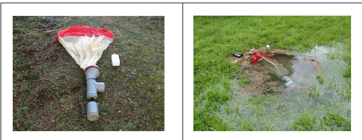
Filet à large ouverture : détail et pose in situ
