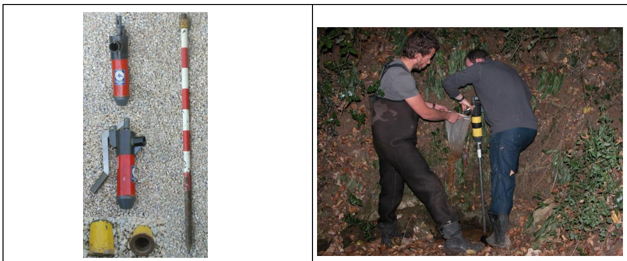
Pompe Bou-Rouch : détail et maniement in situ
