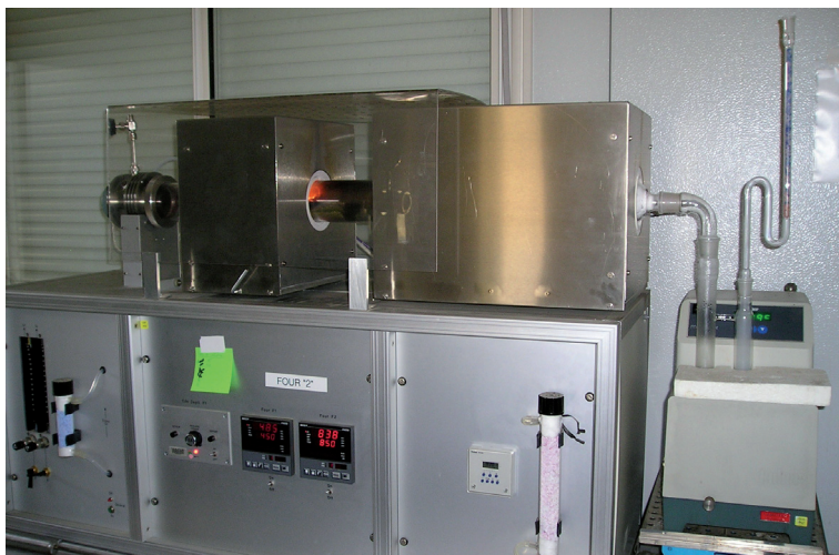
Figure 2 – Four à combustion utilisé en laboratoire pour l'analyse du tritium. Combustion oven currently used in laboratories for tritium analysis.
