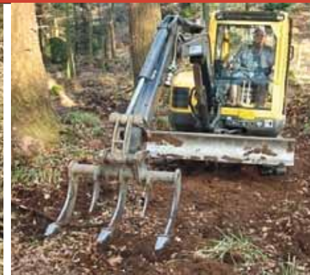
▲ De gauche à droite, pioche-herse (PH) et scarificateur réversible (SR). Ce sont les deux outils de désherbage mécanique testés sur minipelle.
