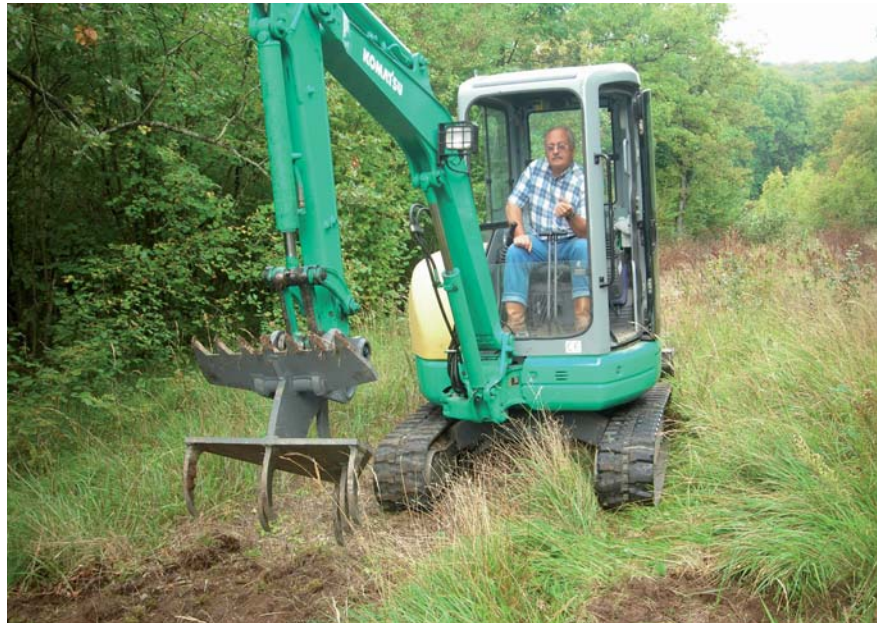
Le travail mécanique sur pelle miniaturisée, technique PH (pioche herse).
