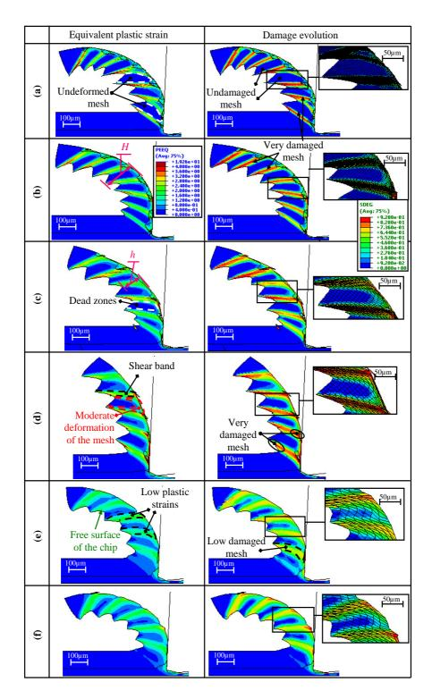
Fig. 14 Effect of the mesh size on the chip morphology: (a) 4  $\mu$ m, (b) 6  $\mu$ m, (c) 8  $\mu$ m, (d) 10  $\mu$ m, (e) 12  $\mu$ m and (f) 14  $\mu$ m ( $V_c = 75$  m/min)
