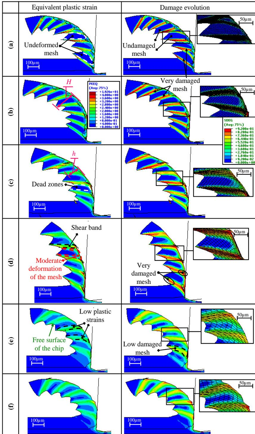
**Fig. 14** Effect of the mesh size on the chip morphology: (a) 4  $\mu\text{m}$ , (b) 6  $\mu\text{m}$ , (c) 8  $\mu\text{m}$ , (d) 10  $\mu\text{m}$ , (e) 12  $\mu\text{m}$  and (f) 14  $\mu\text{m}$  ( $V_c = 75$  m/min)
