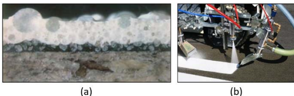
Fig. 4. Composition et pose d'un marquage rétro-réfléchissant blanc à base de peinture à l'eau : (a) coupe, (b) une machine applicateur adapté [10].
