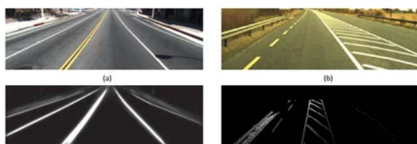
Fig. 8. Deux exemples de détection de ligne de marquages : (a) par une caméra [34], (b) par un lidar [35]
