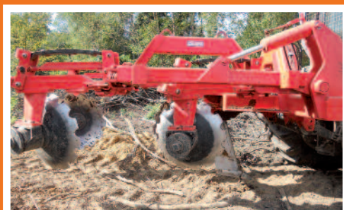
Outil Culti 3B (dent de sous-solage et 4 disques)
