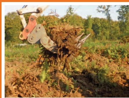
Scarificateur réversible® et arrachage de la fougère aigle
