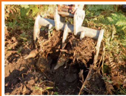
Extraction de la fougère avec le scarificateur réversible (travail en rétro)
