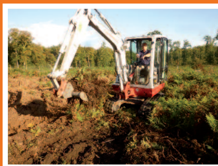
Extraction de la fougère avec le scarificateur réversible (travail en rétro)
