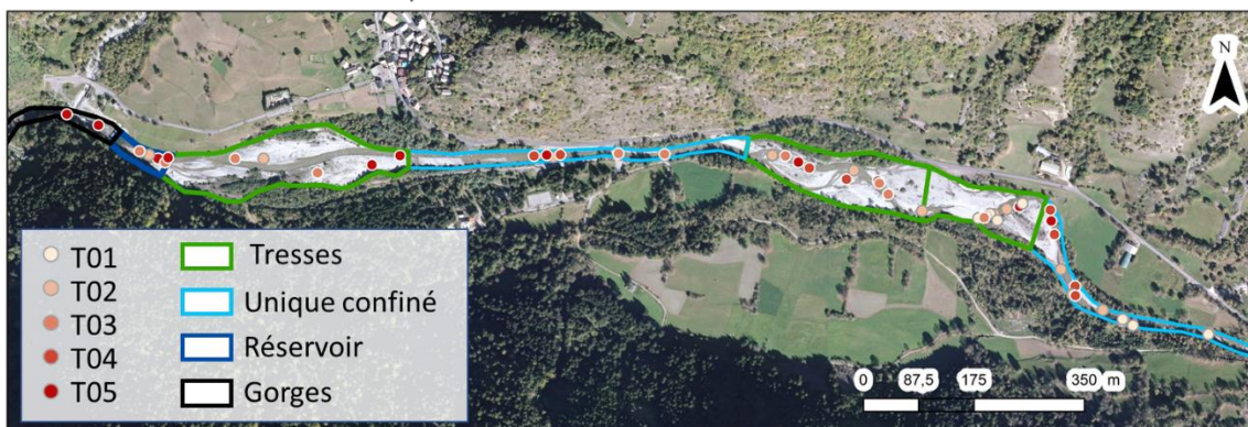
Figure 7. Exemple de l'effet de la morphologie du cours d'eau sur le dépôt des traceurs sédimentaires sur la Séveraisse à Villard Loubière.
