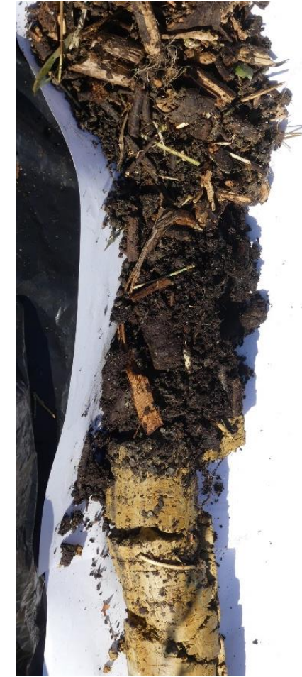
Coupe verticale d'un filtre de BB
