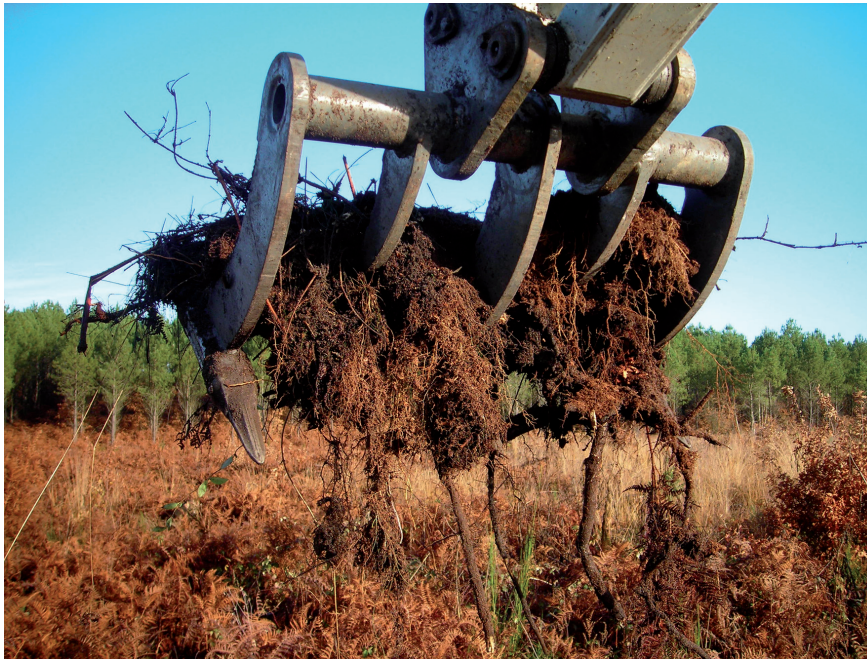
Scarificateur réversible "Becker" monté sur mini pelle de 3,5t.
