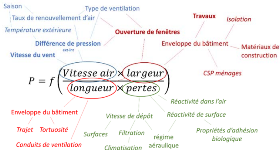
Figure 65 : Schéma relationnel simplifié des paramètres susceptibles d'intervenir sur le facteur de pénétration P d'une substance gazeuse ou particulaire
