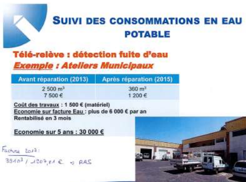
Cas 1. Détection d'une fuite au niveau de la cours d'un bâtiment communal
