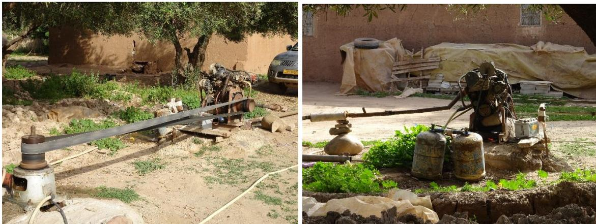
Figure 20. Puits équipé d'une pompe et d'un moteur alimenté par le gaz butane (photos prises le 18/04/2019)
