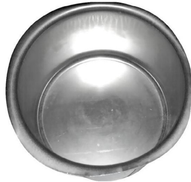
Fig. 24. Emboutissage sur tôle inox austénitique issue de la coulée sur bande Myosotis [13].
