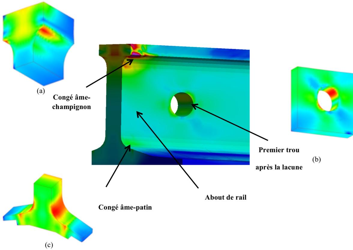
Fig. 14. Les zones critiques du rail en fatigue.
