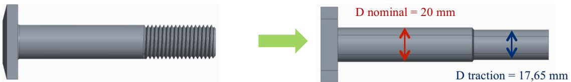
Fig. 3. Géométrie simplifiée des boulons – Creo Parametric.
