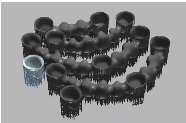
**Fig. 4.** View of the CAD model of the prosthetic crown with supports.**Fig. 4.** Vue du modèle CAO de la couronne prothétique avec les supports.
