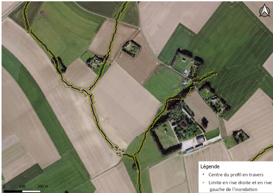
Figure 84 : Représentation d'un profil en travers après traitement. Chaque profil se résume en trois points : un point pour le centre du profil (avec comme attribut l'altitude de l'inondation) et deux points en rive droite et en rive gauche délimitant la largeur d'inondation.
