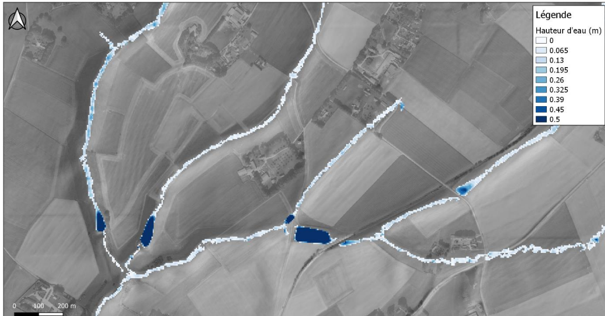
Figure 101 : Extrait de la cartographie des hauteurs d'eau pour le scénario « ref1 » et pour la pluie de période de retour 10 ans.
