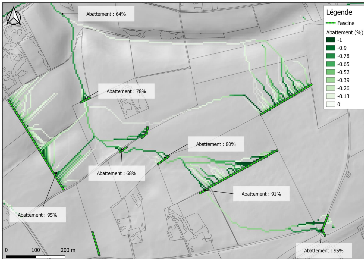
Figure 99 : Cas synthétique illustrant le principe d'aménagement en cascade permettant de maintenir un abattement élevé aux différentes échelles spatiales.
