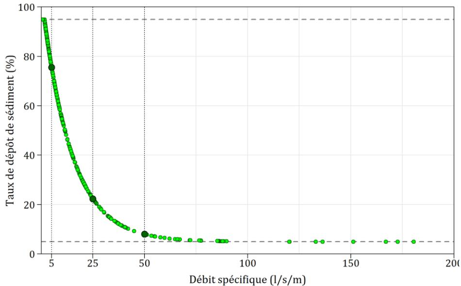
Figure 95 : Fonction de dépôt de sédiments des fascines et des haies dans le modèle WaterSed.
