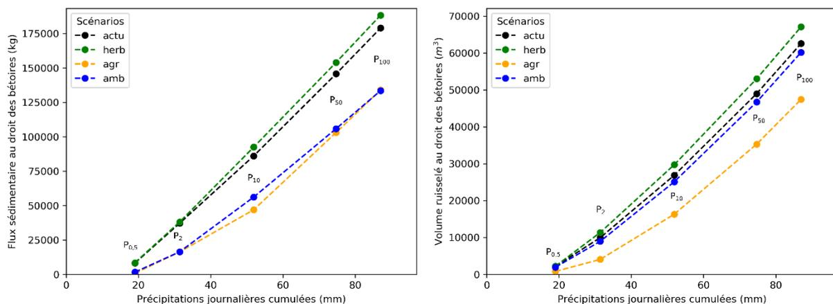
Figure 134 : Flux sédimentaires (kg) et volumes ruisselés (m<sup>3</sup>) simulés par le modèle WaterSed au droit des bétaires connectées sur le BAC de Radicatel pour les cinq pluies de projet selon les différents scénarios prédéfinis. (actu = scénario actuel 2018 ; amb = scénario d'aménagement d'hydraulique douce ambitieux ; agr = amélioration des pratiques agricoles sur 50% des surfaces en culture ; herb = retournement de 33% des prairies).
