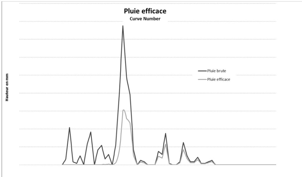
Figure 48 : Mécanisme de pluie brute et pluie efficace.
