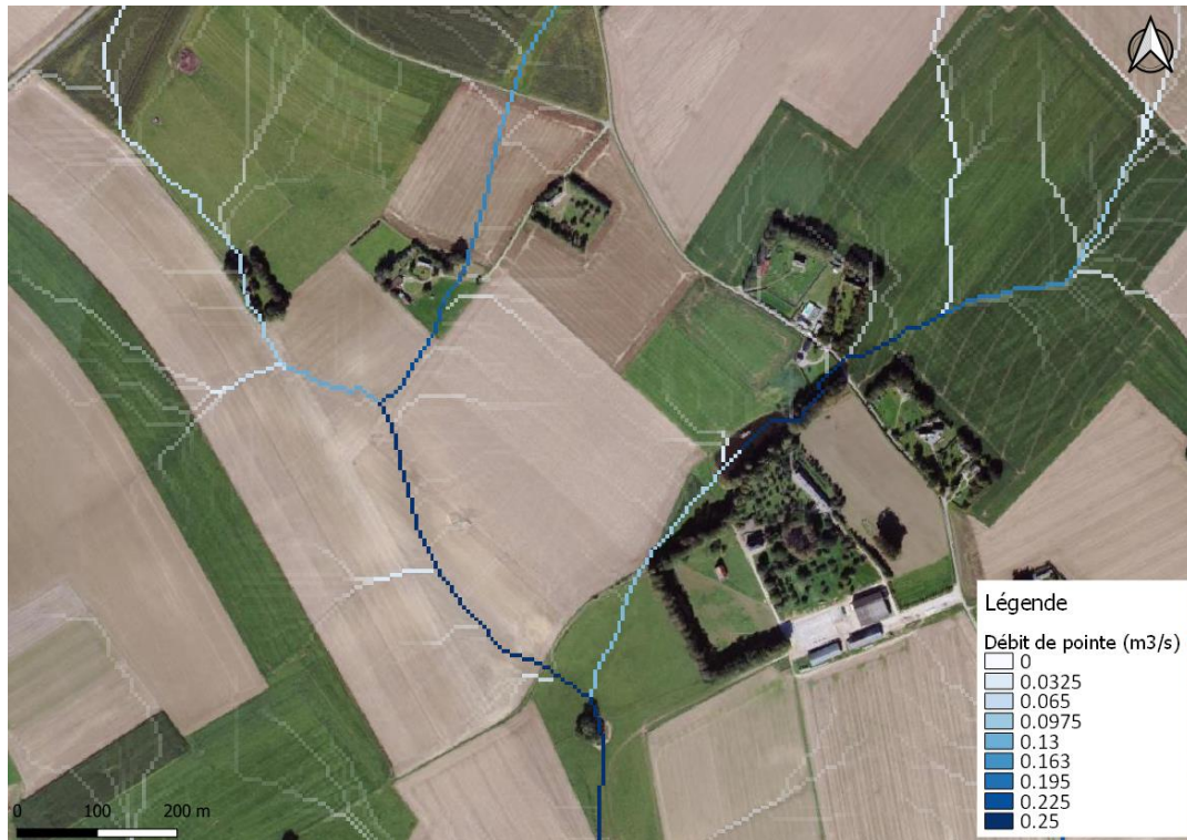
Figure 77 : Exemple de cartographie des débits de pointe en sortie du modèle WaterSed.
