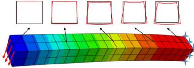
Figure 3 – Déformation des sections d'une poutre cantilever
