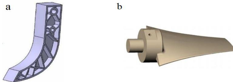
Figure 1 – Exemples de structures complexes : (a) support de pédale, (b) pale de ventilateur
