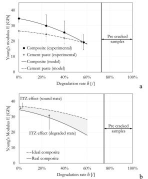
Fig. 6 - Evolution of the Young's modulus of the cement paste and the composite as a function of the degradation rate(a) and evolution of the Young's modulus of the real and ideal composites as a function of the degradation rate(b) / Evoluţia modulului lui Young al pastei de ciment și a compozitului ca funcţie de rata de degradare (a) și evoluţia modulului lui Young al compozitelor reale și ideale în funcţie de rata de degradare (b).
