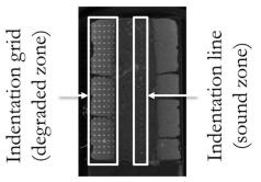
Fig. 2 - Single indentation force/depth example (a); location of the indentation grid (b) / Exemplu de curbă forță/adâncime pentru o indentare individual (a); localizarea grilei de puncte de indentare (b).
