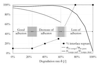
Fig. 8 - Evolution of the quality of the cement paste/aggregate adhesion as a function of the chemical degradation rate Evoluția calității adeziunii dintre pasta de ciment și agregat ca funcție de rata de degradare.
