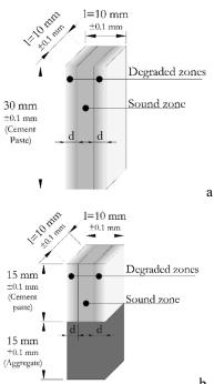
Fig. 1 - Geometries of cement paste samples (a) and composite samples (b)/ Geometria eşantioanelor din pastă de ciment (a) și compozite (b).
