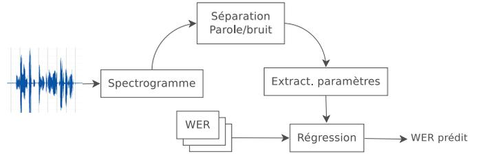
Figure 2 – Architecture du système de prédiction.
