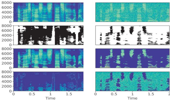
Figure 4 – Séparation de la parole et du bruit. À droite le fichier propre et à gauche le même fichier bruité. De haut en bas : spectrogramme, MB, parole isolée, bruit isolé.
