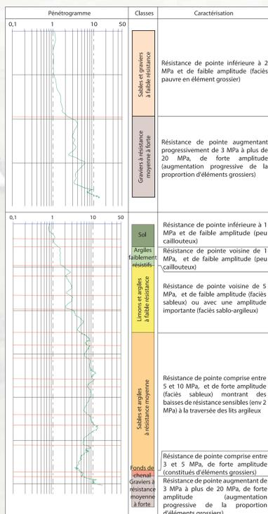
Fig 5 : Principe d'interprétation des pénétrogrammes et détermination des faciès géotechniques types pour cette étude.
