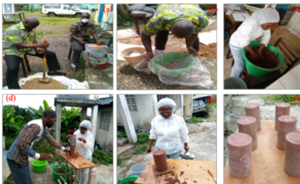
Fig. 2: dispositif expérimental : (a) broyage ; (b) tamisage ; (c) malaxage ; (d) moulage à l'aide d'un moule cylindrique ; (e) briquette fraîche ; (f) briquette séchée.
