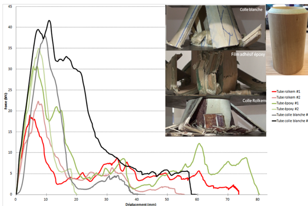
Fig. 3 : Influence des 3 types de colle sur les courbes force-déplacement pour des tubes bois
