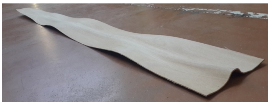
Fig. 2 : Défaut typique des placages rejetés du fait de leur ondulation
