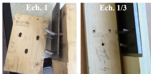
Fig. 6 : Rupture des assemblages : à gauche échelle 1, à droite échelle 1/3
