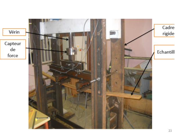
Fig. 2 : Essai statique quatre points
