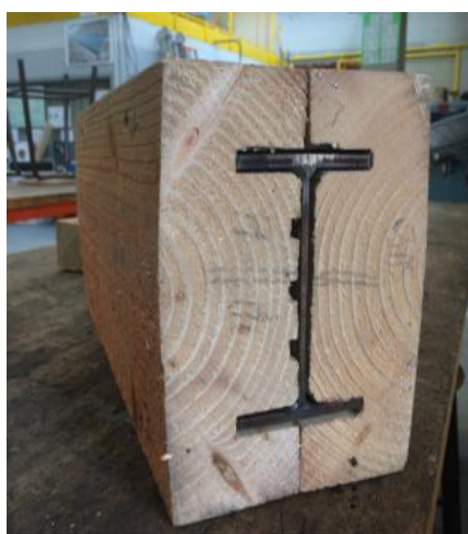
Fig. 3 : Poutre entièrement enrobée (pin)
