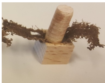
Fig.2 : Echantillon soudé : P_s=6\text{MPa} , v=0.44\text{m.s}^{-1} .
