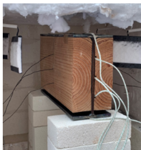
Fig. 4 : Poutre partiellement protégée (douglas)
