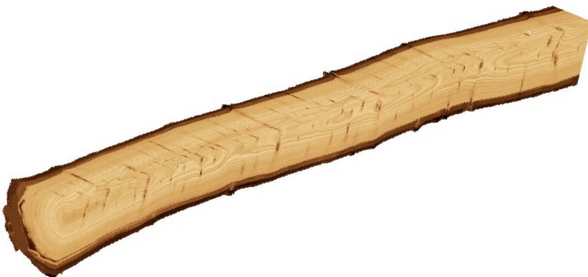
Fig. 3 : Simulation de débit à partir d'images tomographiques
