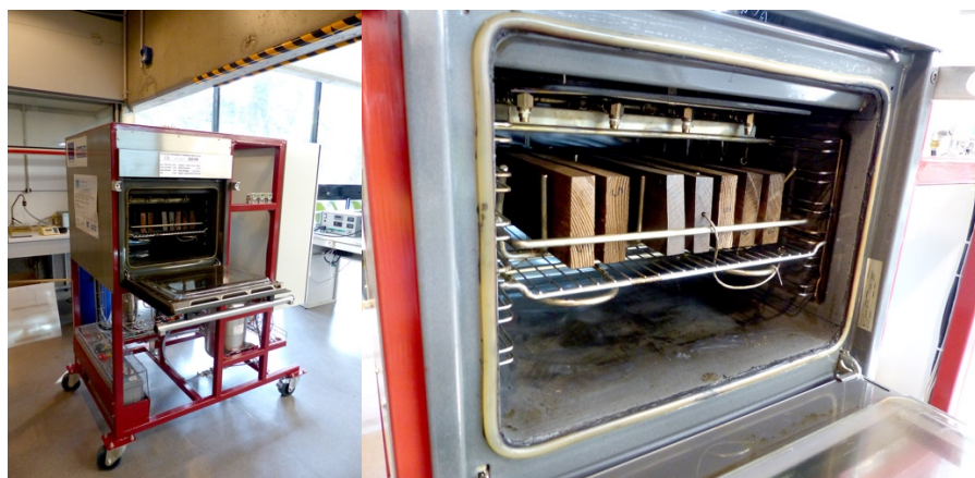
Fig. 1 : Le pilote de traitement thermique.
