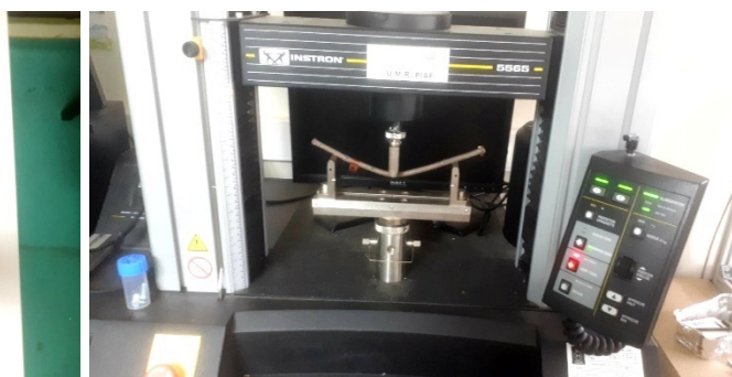
Fig. 2 : Branche d'érable après rupture lors d'un essai de flexion 3 points
