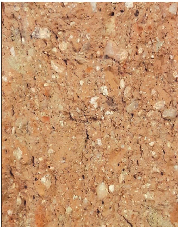
Fig. 3 – Cliché macroscopique du matériau de la tuile estampillée de Bibracte (cliché : F. Delencre).
