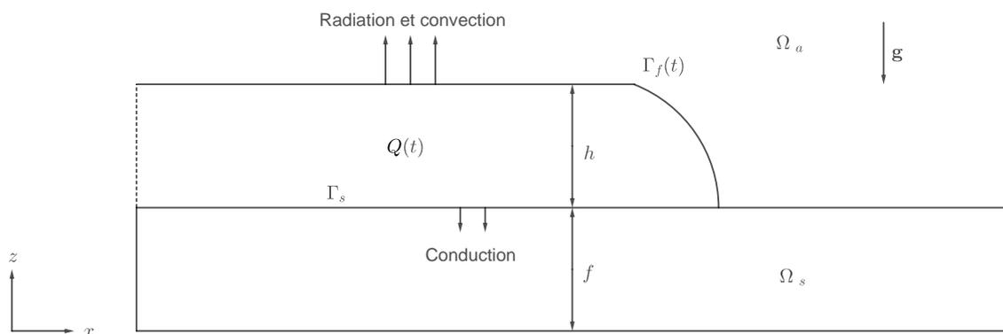
Figure 1 : Schéma de principe de l'étalement.
