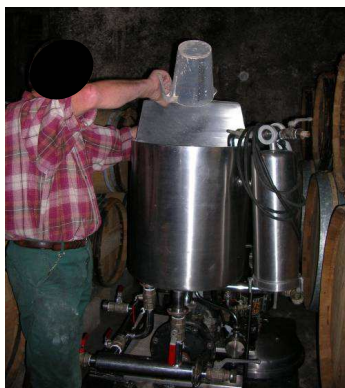
Exposition lors de la phase d'alluvionnage continu nécessitant l'alimentation au pichet de la cuve en terres de diatomées
