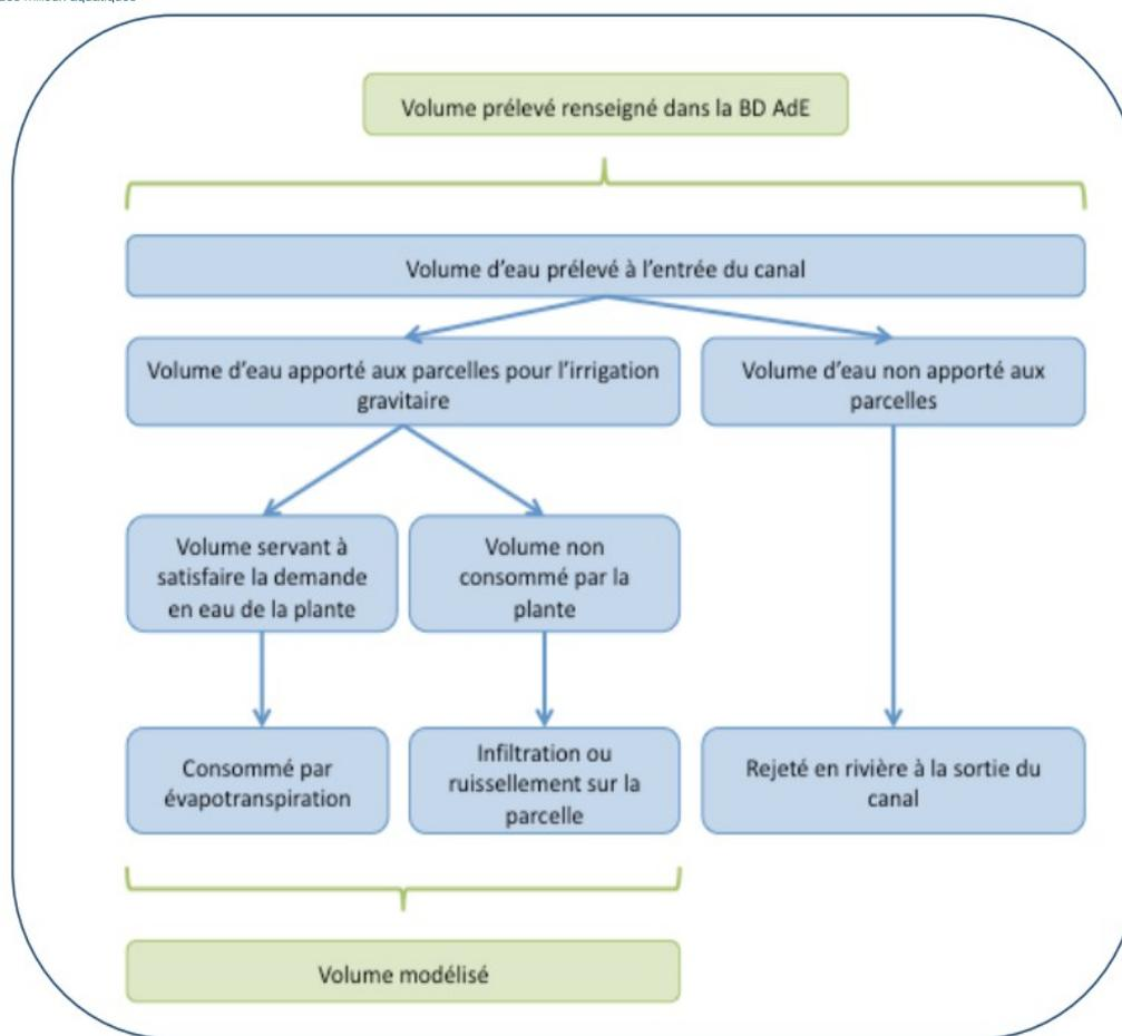
**Figure 25 : Différence entre les prélèvements modélisés et les prélèvements renseignés dans la BdD AE pour l'irrigation**
