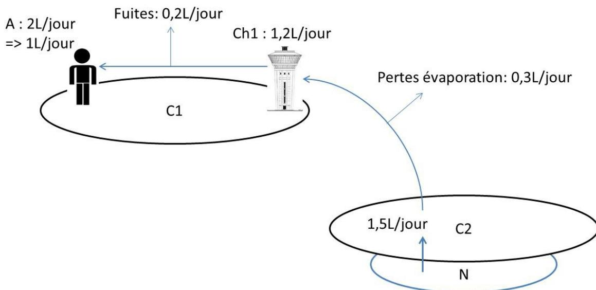
**Figure 7 : Schéma des prélèvements en eau**
