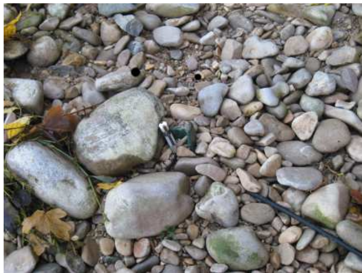
Figure 3 : Position de la sonde in situ . En fait, la sonde doit affleurer le sédiment mais elle est ici positionnée plus haut que le piquet, contrairement à l'usage, afin qu'on la distingue mieux sur la photo
