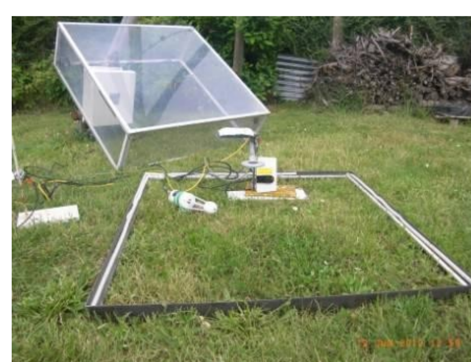
Figure 6 : Dispositif de mesure de l'évapotranspiration par chambre mobile. Il mesure la radiation incidente ainsi que la température et l'humidité de l'air ventilé en interne. La mesure dure environ 2mn dont les 30 premières secondes sont exploitées.
