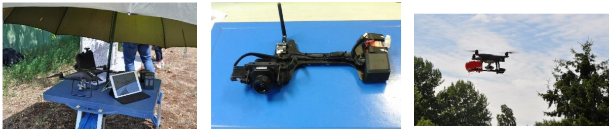
Figure 1. Dispositif d'acquisition d'images thermiques infrarouges. De gauche à droite : le drone, la tablette Ipad et les batteries ; la nacelle avec la caméra thermique ; le drone en vol avec la nacelle et la caméra thermique « sous abri ». Photographies prises lors de la mission drone du 8 juillet 2019 (Carré de l'Escadron, sur le Plateau de Frescaty).
