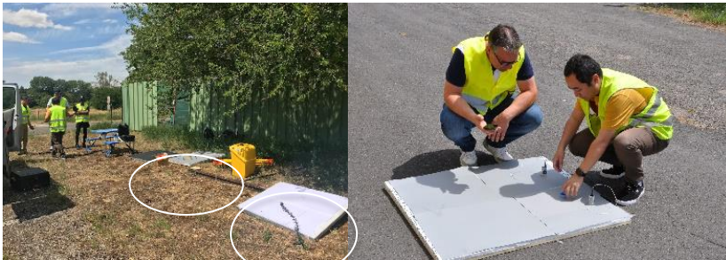
Figure 2. A gauche : les 2 ellipses blanches entourent les 3 cibles thermiques en polystyrène posées au sol (cible blanche, cible noire et cible grise) ; à droite : cible grise avec sonde Tynitag . Photographies prises lors de la mission drone du 8 juillet 2019 (Carré de l'Escadron, sur le Plateau de Frescaty).
