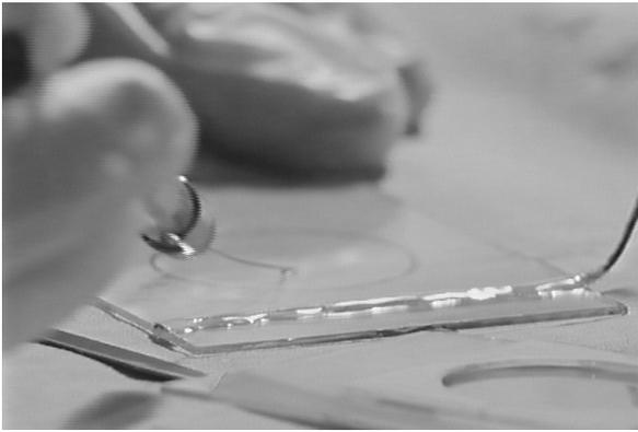
FIG. 12: Étalement des lipides sur les plaques de verre recouvertes d'ETO
