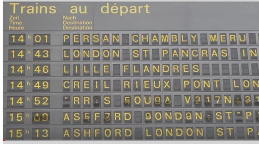
FIGURE 3 : Panneau d'affichage à palettes mécaniques d'une gare ferroviaire.
