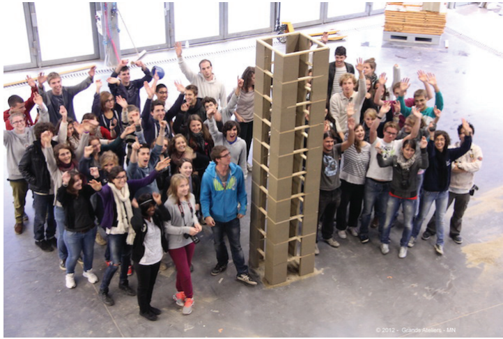
Fig. 5 La "tour de sable", construite avec du sable, de l'eau et des fibres, fait 3 m. de hauteur, et ses murs seulement 4 cm d'épaisseur, photo : amàco
