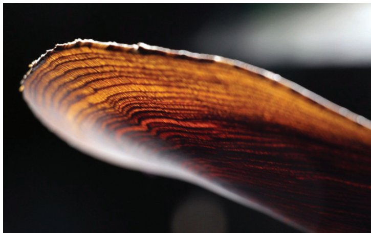
Fig. 9 Une fine tranche de bois rétro-éclairée rend visible sa structure et aide à comprendre ses déformations, photo : amàco
